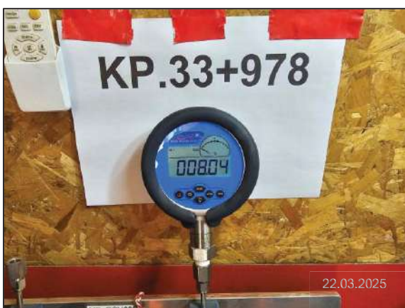
ฉ) ปรับลดแรงดันน้ำก่อนระบายน้ำทิ้ง
