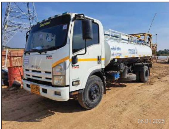
ง) รถดูด (Vacuum) สูบโคลนโซเดียมเบนโทไนต์ตามแนวที่มีการทะลักขึ้นมา
