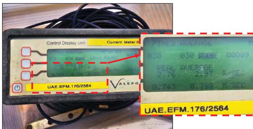
จ) ควบคุมอัตราการระบายน้ำออกจากท่อส่งก๊าซ ภายหลังการทดสอบท่อ
